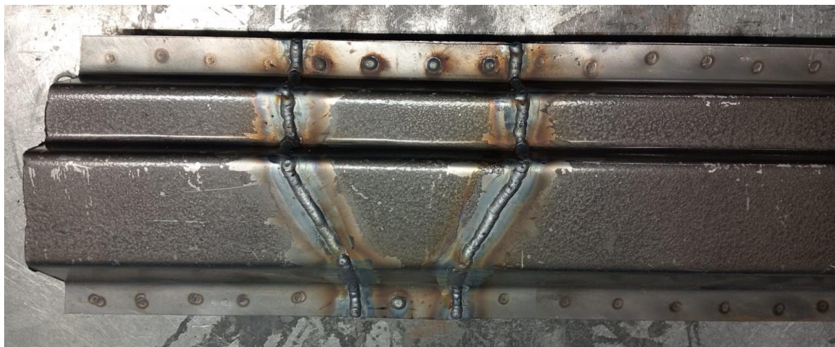
Сварка ремонтной вставки А3
