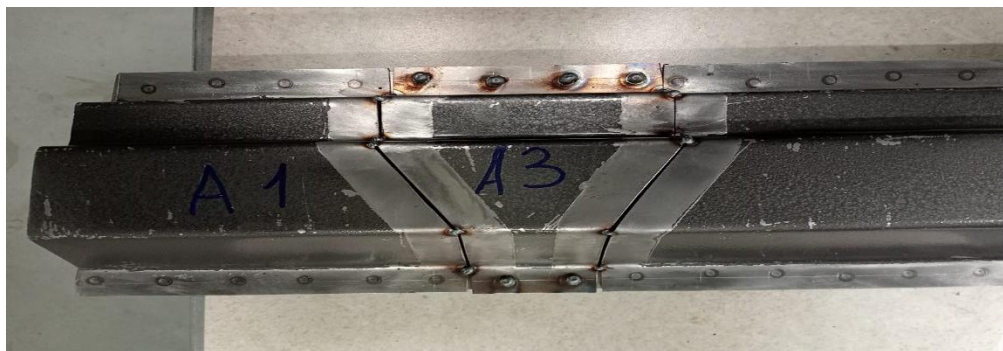
Установка ремонтной вставки А3
