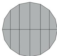
На minor модели создано необходимое и достаточное количество рёбер на закругленных или кривых частях для последующего сглаживания объекта
