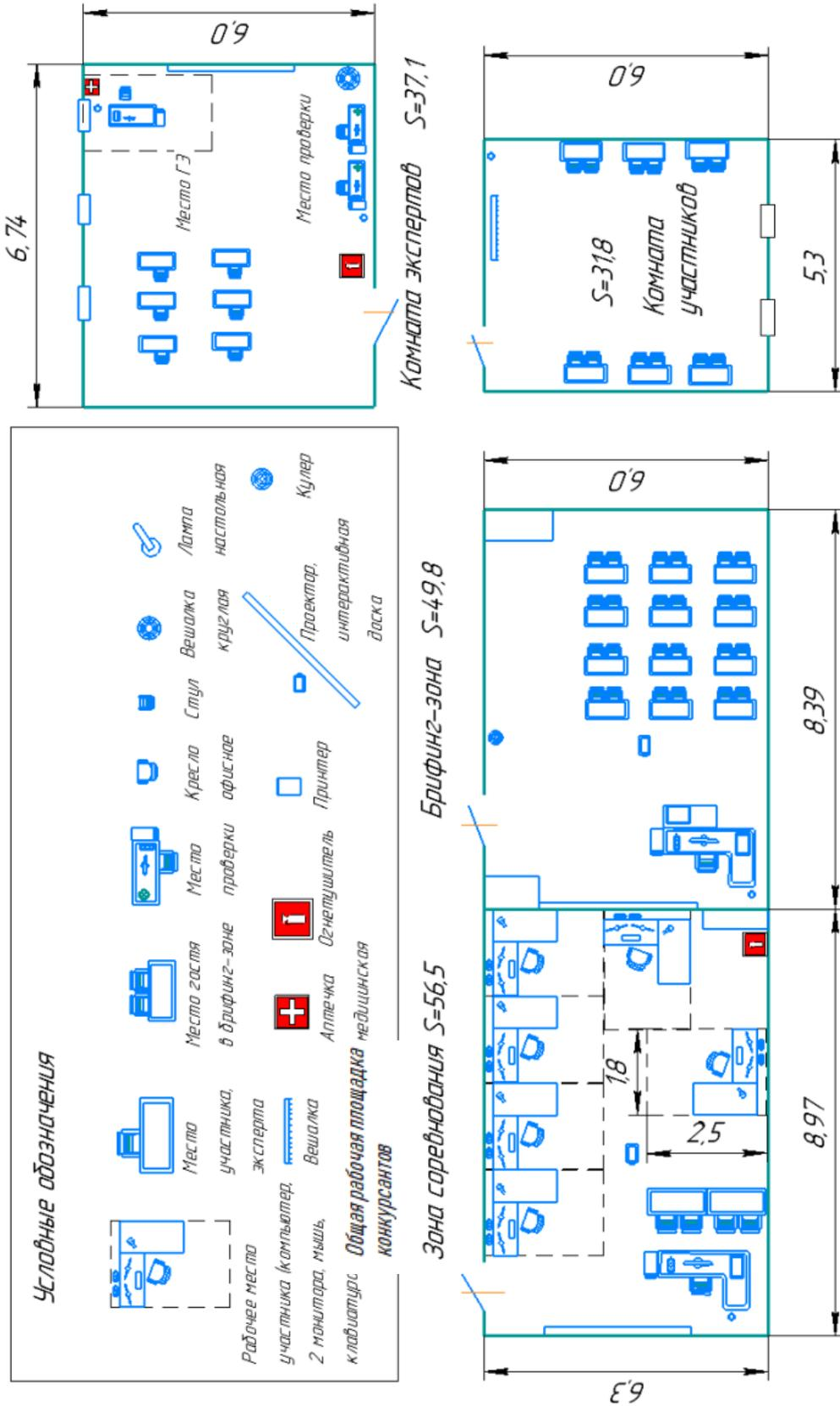
Каждое рабочее место должно быть оборудовано наличием не менее 4 электрических розеток 220 Вольт (2 кВт). Допускается использование переходников и удлинителей для подключения мониторов, ПК и др. оборудования. Рекомендуется соединить все ПК на конкурсной площадке в единую информационную сеть без выхода в интернет.
