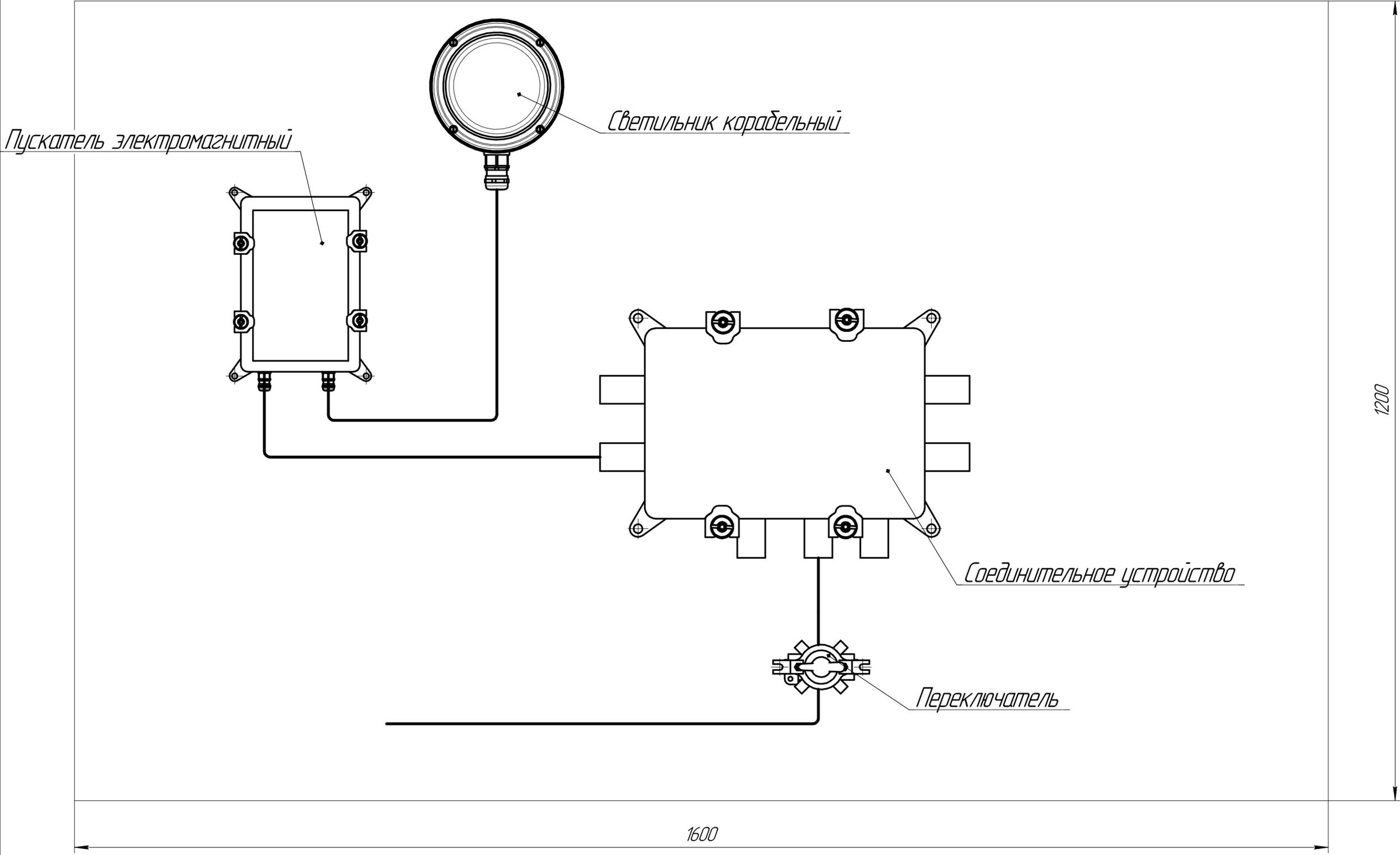
1 Монтаж выполнить по схеме электрической подключения.
